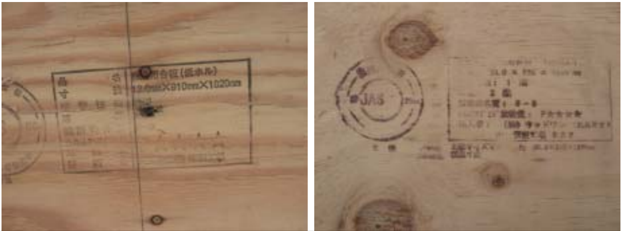
左/1階下地 12mm 右/2階下地 28mm
